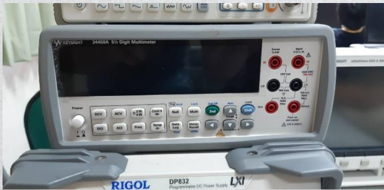
桌上型三用電錶 (型號：Keysight 34450A)
